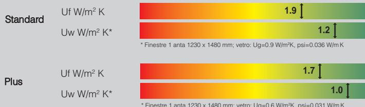
La trasmittanza termica U è il flusso di calore che passa attraverso il serramento per m<sup>2</sup> di superficie e per ogni grado di differenza di temperatura tra interno ed esterno. L'unità di misura della trasmittanza termica è il W/m<sup>2</sup>K.
