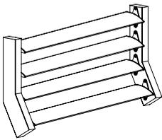
D8 - Frangisole orizzontale per sottostruttura. Angoli prestabiliti.
