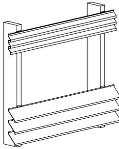
D10 - Frangisole orizzontale fisso per sottostruttura.
