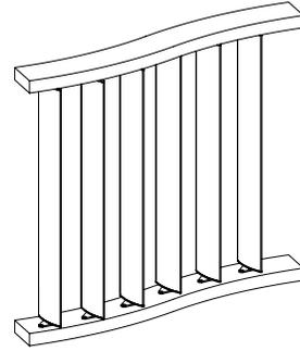
D12 - Frangisole verticale per sottostruttura. Angoli prestabiliti.
